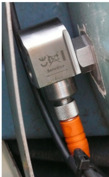
Figura 1: Los acelerómetros deben montarse de manera segura sobre una base limpia y sólida. Además, deben ubicarse lo más cerca posible al componente monitoreando.
