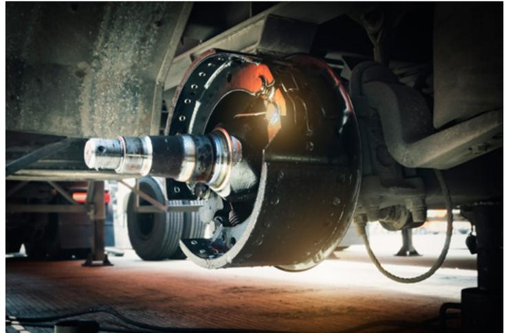
provocaría un contacto metal con metal entre la zapata de freno y el rotor.
